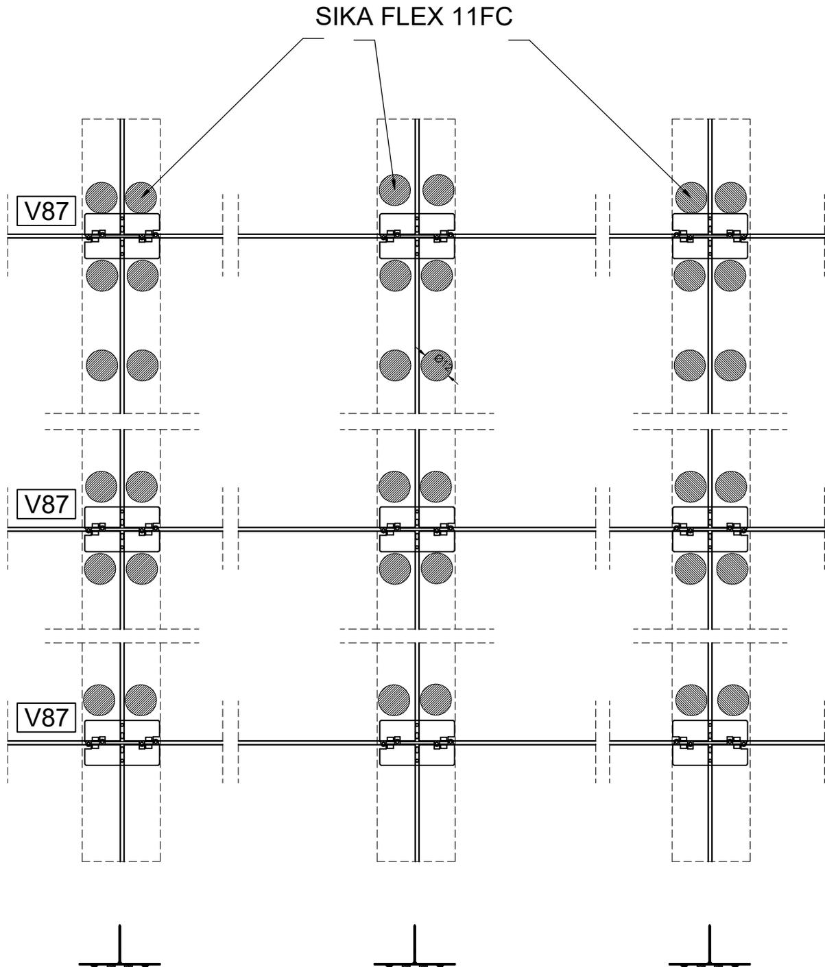
Sirov aluminijumski profil pripremljen za lepljenje prema specifikaciji proizvođača lepka.
