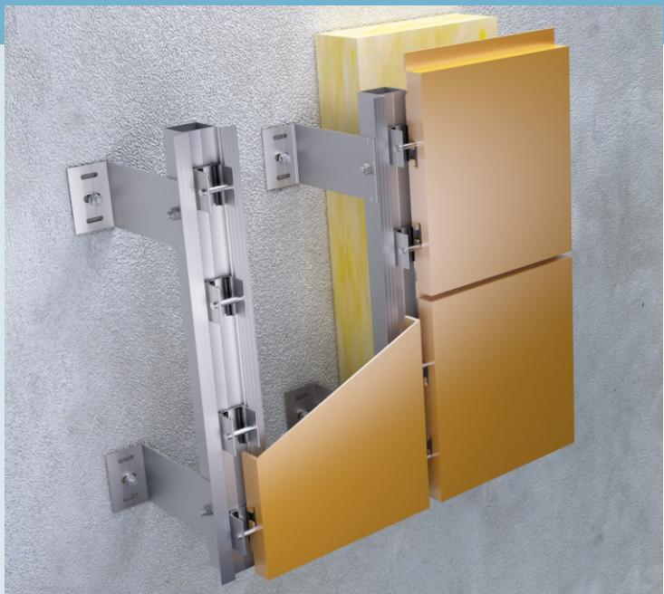
Sistem aluminijumske podkonstrukcije namenjen prihvatanju posebno formiranih kaset fiksiranih skrivenim nosačima i vidnim prihvatajućim elementima veze u obliku osovina u zoni fuga. Pripremu kasete je moguće odraditi kompletno u radionici, kako bi na gradilištu ovaj suvi postupak montaže bio brz i efikasan. Naziv je dobio prema načinu postavljanja kasetnih obloga na manje nosače, koji se pozicioniraju klizanjem na noseći deo podkonstrukcije i kasnjim fiksiranjem na istu (klizač-slider).
