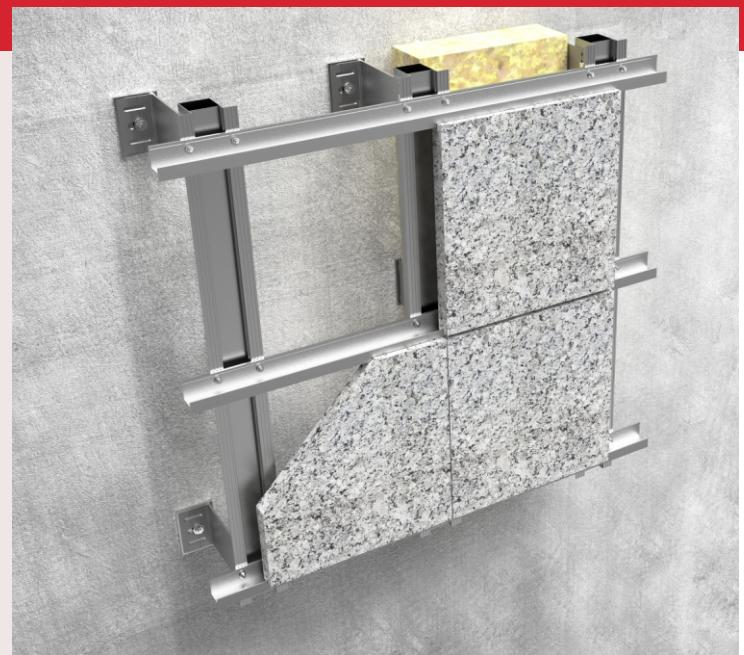
Sistem aluminijumske podkonstrukcije koji je namenjen prihvatanju ravnih ploča, najčešće od prirodnog kamena, sigurno fiksiranih horizontalnim profilima delimično vidljivim sa lica fasade u zoni horizontalnih fuga, koji se u zavisnosti od zahteva u projektu mogu plastificirati u traženoj boji po RAL ton karti. Postupak ugradnje je suv, uz jednostavnu montažu i kompletну radioničku pripremu. Debljina fasadne obloge može biti od 10-40mm u zavisnosti od strukture materijala.
