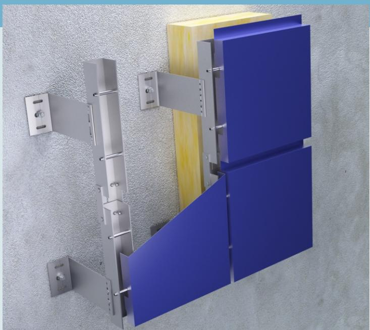
Sistem aluminijumske podkonstrukcije namenjen prihvatanju posebno formiranih kaset fiksiranih skrivenim nosačima i vidnim prihvatajućim elementima veze u obliku osovina u zoni fuga, bolcnama, po čemu je sistem i dobio naziv (bolcna-bolt). Suvim postupkom ugradnje, gotove kasete se preko posebno bočno ukrojenih falceva kače na horizontalno postavljene bolcne.
