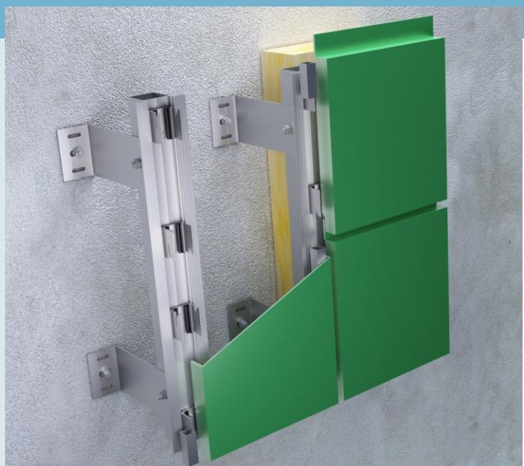
Sistem aluminijumske podkonstrukcije namenjen prihvatanju posebno formiranih kasete fiksiranih skrivenim nosačima i prihvatajućim elementima veze u obliku malih kutijastih elemenata (kutija-box) po kojima je ovaj sistem i dobio naziv. Sustav je postupak montaže, a kompletan pripremu kasete je moguće odraditi u radioničkim uslovima. Tako pripremljene kasete se na gradilištu lako postavljaju prema planiranim pozicijama na fasadi.
