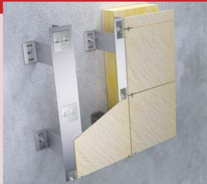
Les systèmes de sous-structures en aluminium qui est destiné à accepter des panneaux plats en céramique de granit, fixés du côté extérieur de la façade à l'aide des porteurs visibles ou cachés, qui selon les exigences du projet peuvent être en couleurs de RAL. Cette méthode d'installation en voie sèche n'est pas trop exigeante pour l'installation et elle est extrêmement stable avec les capacités porteuses très élevées. Pour cette raison ce system est utilisé pour les panneaux de façades lourds.
