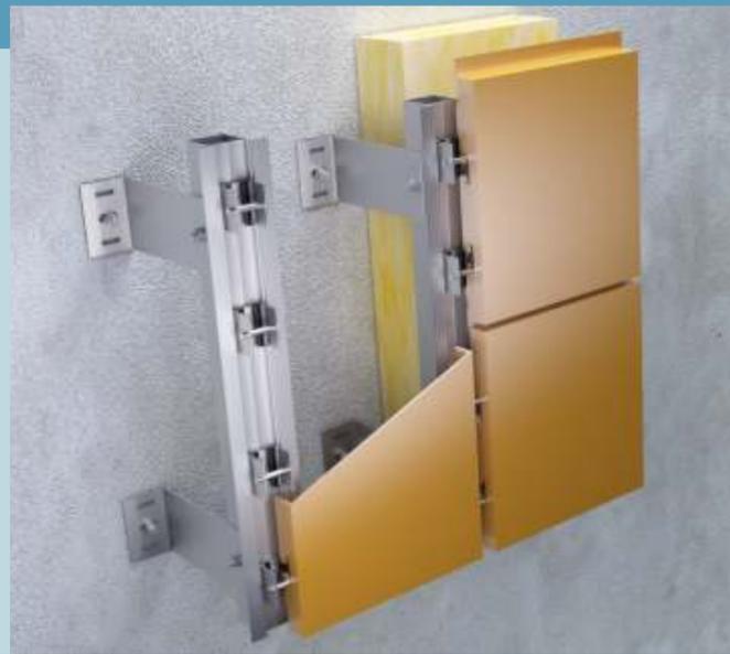
Le système de sous-construction qu'on utilise pour connecter des cassettes spéciales qui sont fixées avec les porteurs cachés en forme d'essieu dans le carrelage. Il est possible de faire une préparation complète des cassettes dans l'atelier pour accélérer le montage en voie sèche sur le chantier et pour le faire plus efficace. Les porteurs, sur lesquels on place des cassettes, sont positionnés en faisant coulisser la sous-construction qu'on fixe ultérieurement (le glisseur-slider).
