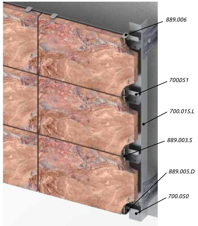
Kopče sa perima 889.005.D, 889.003.S i 889.06 kao i na prethodnoj slici montiraju se na kamene ploče u slulaju vertikalnog razmaka redova fasade. Ostali elementi podkonstrukcije mogu se videti na prethodnim slikama.
