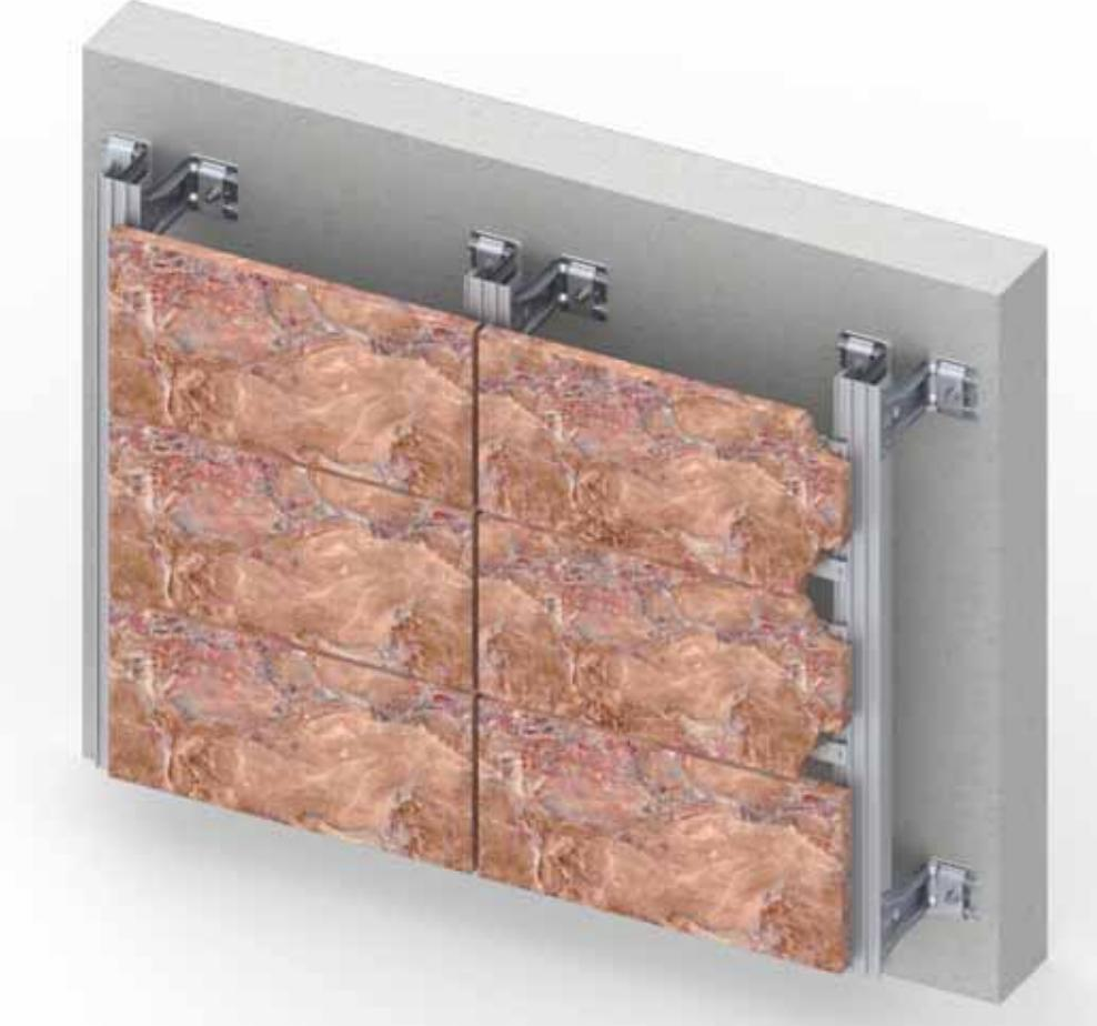
**9) Kamena fasada sa nevidljivim zalivenim kopčama/Stone facade with glued, invisible buckles**
