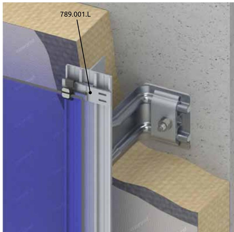
Prema nekim svojim karakteristikama keramičke fasade su slične staklenima. Keramika je krta, ali u nešto manjoj meri nego staklo pa je i ovde potrebno zaštititi fasadnu keramičku ploču od dodira sa metalnom kopčom (24).
