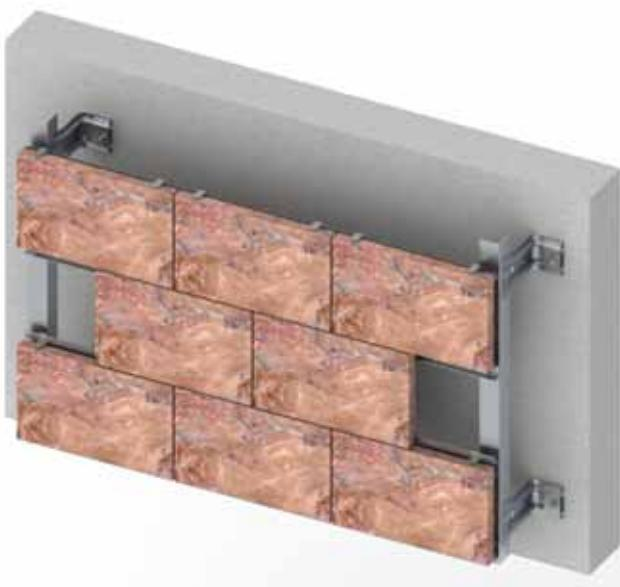
Kopče sa perima 889.005.D, 889.003.S i 889.06 ubacuju se u izbušene otvore u kamenim pločama. Na ovaj način ploče se vertikalno poravnavaju i fiksiraju. Horizontalni nosivi profili 700.050 i 700.051 vijcima se učvršćuju za vertikalni profil 700.015.L.
