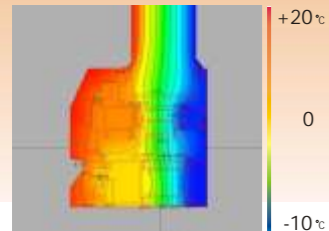
propagazione delle isoterme attraverso la sezione completa della finestra
