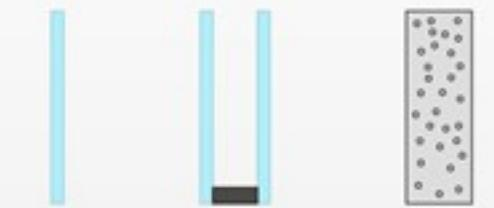
Система поддерживает однослойные и двухслойные стеклопакеты, а также наполнение из других подходящих материалов, общей ширины от 4мм до 30мм.
