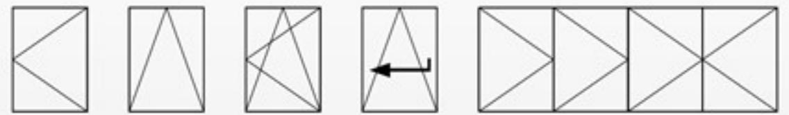
Готовые элементы, на основании способа открытия, могут быть адаптированы к любой концепции пространства и различным функциональным требованиям заказчика. Поддержаны варианты открывания следующих типов: поворотного, поворотно-откидного, отодвигающегося, раздвижного-откидного и гармошка. Несколько способов открытия, простое сочетание элементов и модульность системы обеспечивают быструю, простую и экономичную обстановку.
