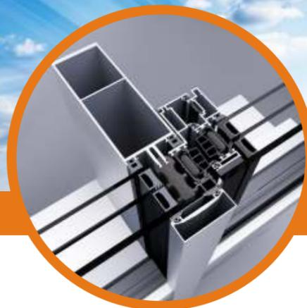
Das System der kontinuierlichen verglasten Aluminiumfassade zeichnet sich durch klar betonte horizontale und vertikale Profile auf der Außenseite der Fassade aus. Die sichtbaren Profile stellen Druck- und Abdeckkappen dar, welche die Glasfüllungen an der primären Fassadenkonstruktion aus vertikalen und horizontalen Säulen befestigen.
