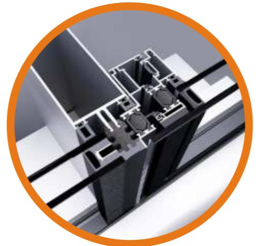
Sistem kombinovane aluminijumske ostakljene fasade odlikuje se naglašenim horizontalnim profilima kapa sa spoljne strane fasade, dok po vertikali ovi profili izostaju i ustupaju mesto strukturalnom načinu fiksiranju stakala za primarnu konstrukciju. Kombinacija strukturalnog i kontinualnog sistema nudi širok spektar mogućnosti implementacije različitih dizajnerskih rešenja u cilju naglašavanja unapred odabranih linija i pravaca na fasadama.
